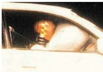
2. Casi 0,1 segundo después del impacto: el cinturón y la bolsa de aire protegen a los ocupantes del vehículo
