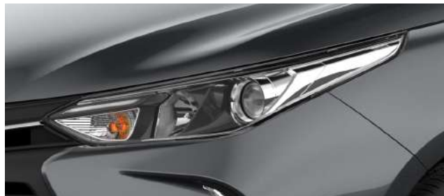
Ópticas delanteras halógenas con regulación en altura y proyector.
