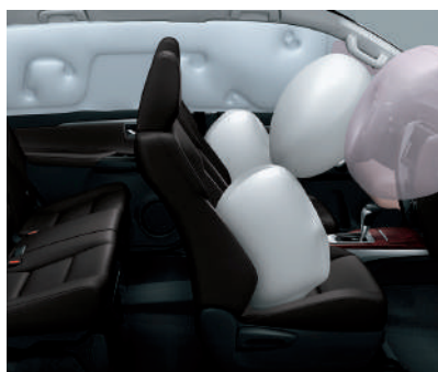
7 airbags: frontales (x2), de rodilla (conductor), laterales (x2) y de cortina (x2)
