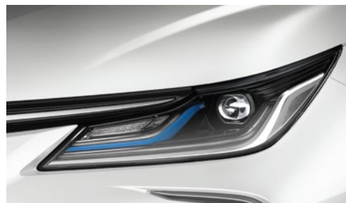
Faros delanteros Bi-LED con regulación en altura. (3)
