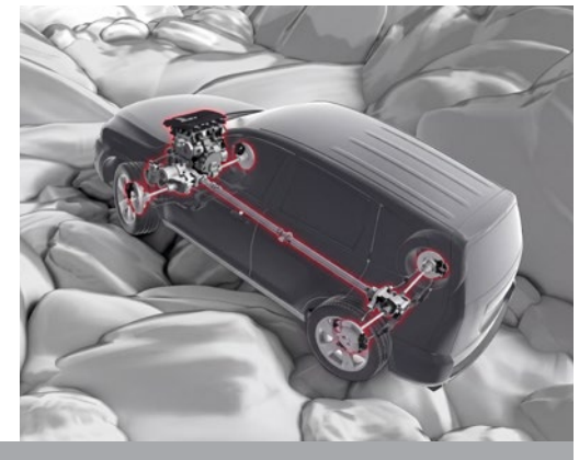
Crawl Control System con asistencia de giro.
